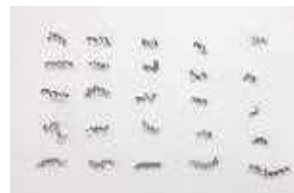
NLB Type Chipbreaker (T1500A)
